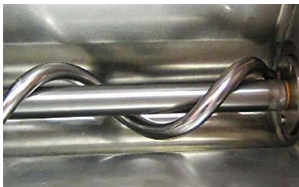
Spirale in acciaio inox all'interno della vasca
